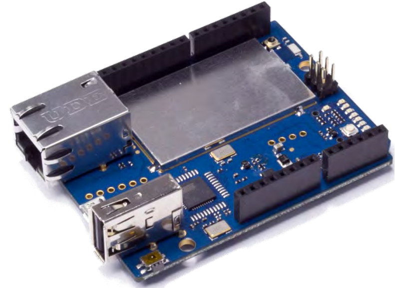
Arduino Yún: * ATmega 32U4 * Qualcomm AR9331 järjestelmäpiiri, jossa Wi-Fi-radio ja suoritin MIPS 24K
