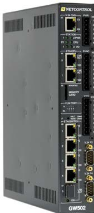
Netcontrollin Netcon GW502-iM on tietoliikennedyöskäytävä ja protokollamuunnin. Siinä on VPN, palomuri, etähallinta ja protokollamuunninohjelmisto. Netcontrol GW502-iM provides firewall, VPN and protocol conversion.
