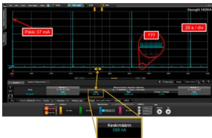
Kuva 4: Mitattu virrankulutus 200 sekunnin aikana antaa jo uutta tietoa laitteen vaihtelevasta virrankulutuksesta.
