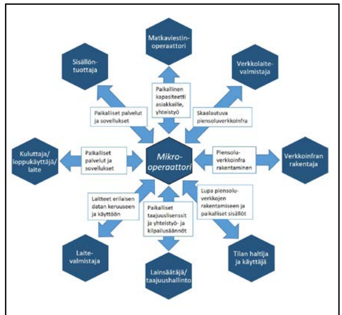
Kuva 3. Tulevaisuuden mikro-operaattorin yhteydet muihin toimijoihin 5G-ekosysteemissä.
