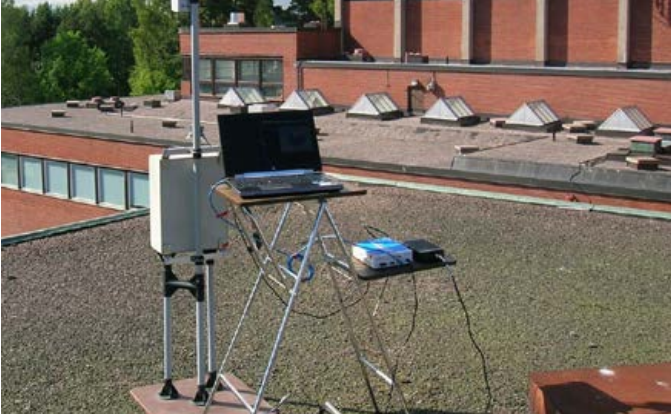
Uudenlainen vähän tehoa kuluttava NB-IoT-tukiasema Aalto-yliopiston katolla. Kokeilu suoritettiin yhteistyössä Ericssonin kanssa ja DNA:n suosiollisella avustuksella.
