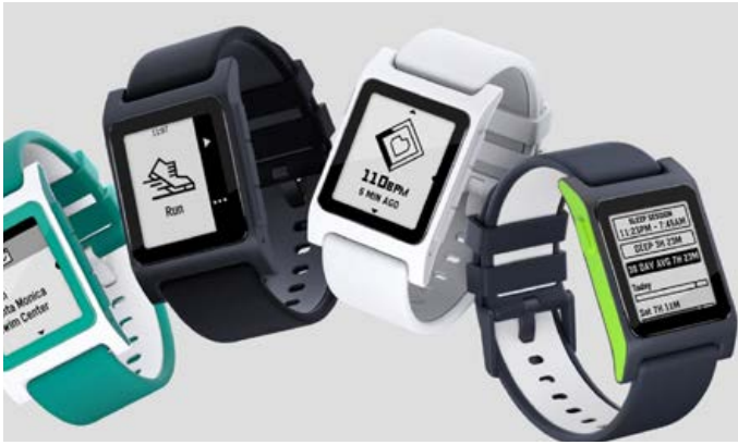
Uusi Pebble 2 käyttää näyttönä koko ajan päällä olevaa e-paper-näyttöä (1,26 tuumaa 144 x 168 pikseliä). Pebble 2 uses 144 x 168 pixel e-paper display.
