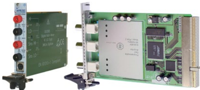
Esimerkkejä hieman edullisemmista PXI-mittauskorteista. Varsinkin Marvin Test Solutionsin 6½-numeroinen digitaalinen yleismittari GX206 ja oikealla TiePie Engineeringin oskilloskooppi TE6100, jossa näytteenottotaajuus on sata megahertsia. Some examples of basic test instruments in PXI form factor, suitable for limited budgets.
