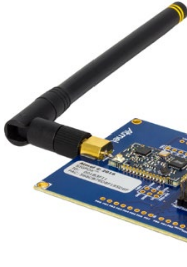
Microchipin/Atmelin ensimmäinen sertifioitu SigFox-kokeilukortti. First certified SigFox evaluation board from Microchip/Atmel
