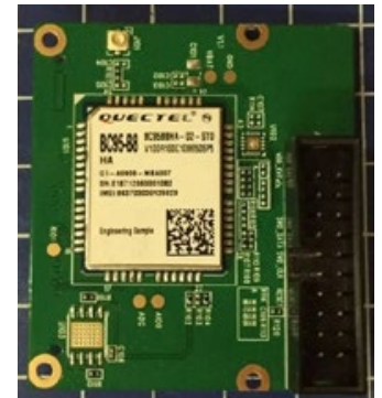
Kiinalaisvalmistaja Quectel on kehittänyt oman NB-IoT-anturiverkkoja tukevan piirimodulin.
