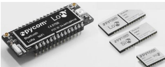
Hollantilainen Pycom valmistaa kehityskortteja, joissa yhdistyy Bluetooth, WiFi ja LoRa, SigFox ja LTE CAT M1/NB1 NB-IOT tai kaikki viisi jopa samassa kortissa. Kuvassa vasemmalla LoPy-kehityskortti ja oikealla kehityskortteja vastaavia moduuleja laitteiden tuotantoon. Pycom offers a series of development boards that combine Bluetooth, WiFi and LoRa, SigFox or LTE CAT M1/NB1 NB-IOT, or even all five on one board.
