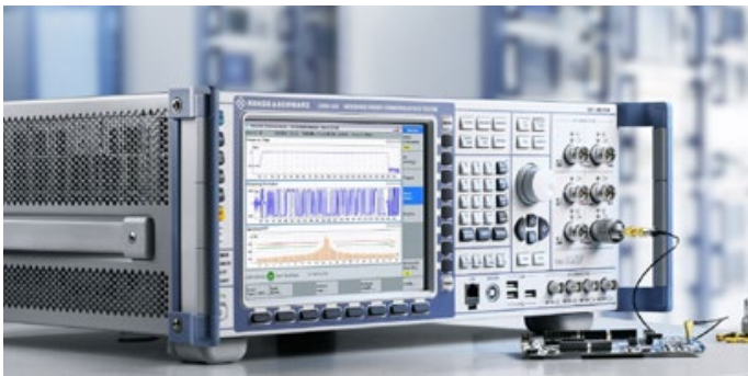
Testervalmistajat ovat tuomassa tukea myös uusille Wifi-ratkaisuille. Kuvassa Rohde & Schwarzin Wifi AX-standardia tukeva testaus-ratkaisu, joka sopii myös Bluetooth-mittauksiin
